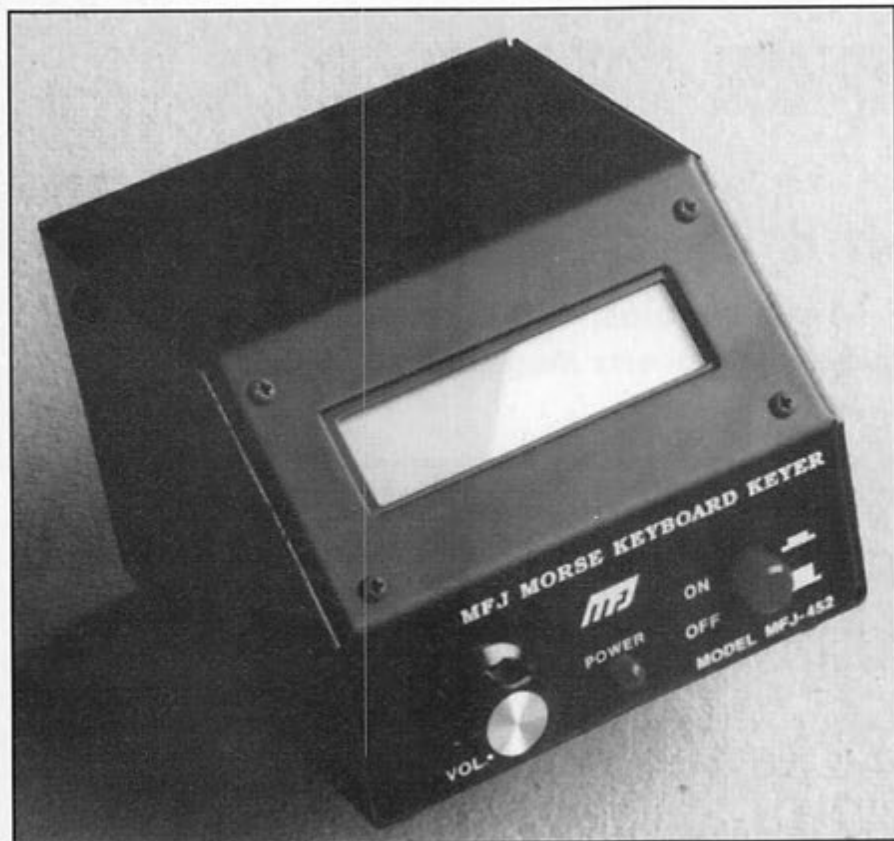
Peu encombrant, le boîtier électronique possède un LCD de 2 x 16 caractères.
