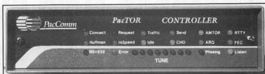
Deux douzaines de LED multicolores indiquent les états de fonctionnement du contrôleur.
