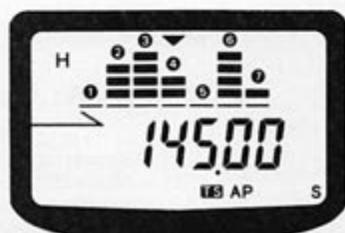
L'espace est fonction du pas des canaux. Le tableau illustre un exemple avec pas de 25 kHz et fréquence centrale de 145,000 MHz.
