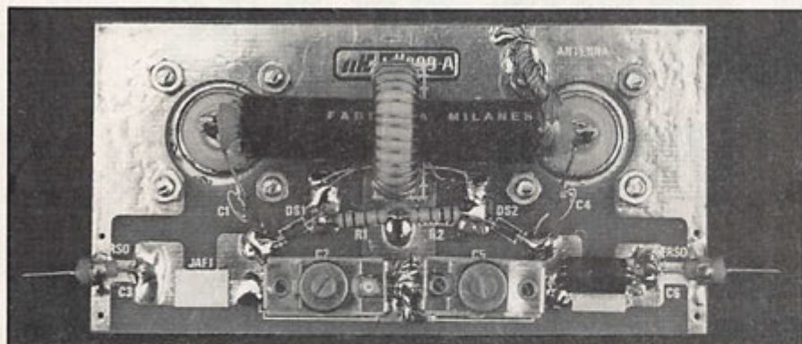
Le prélèvement d'énergie par tore glissé sur câble coaxial.
