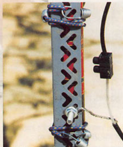
Détail de la fixation du coax sur la GP. Fabrication artisanale !
