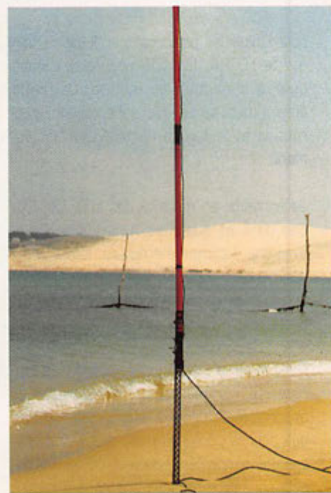
Vue rapprochée de l'antenne "canne à pêche, avec plan de sol idéal.
