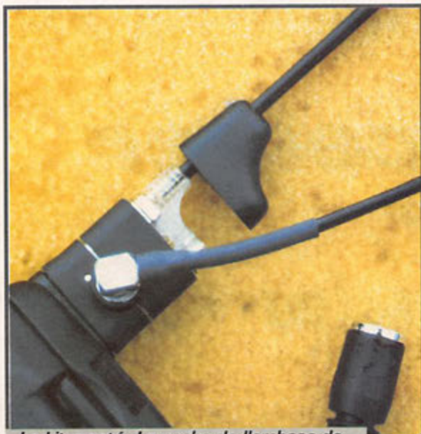
Le kit monté. Le cache de l'embase de l'antenne d'origine n'a pas été remis.
