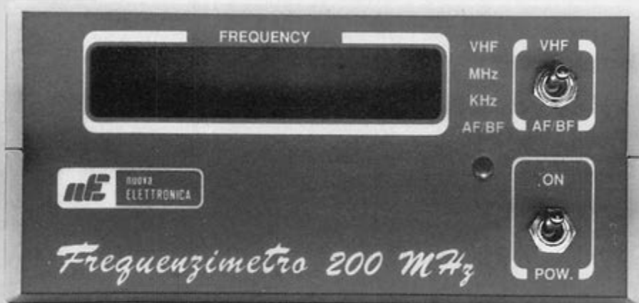
Photo 1. La face avant du fréquencemètre terminé.
