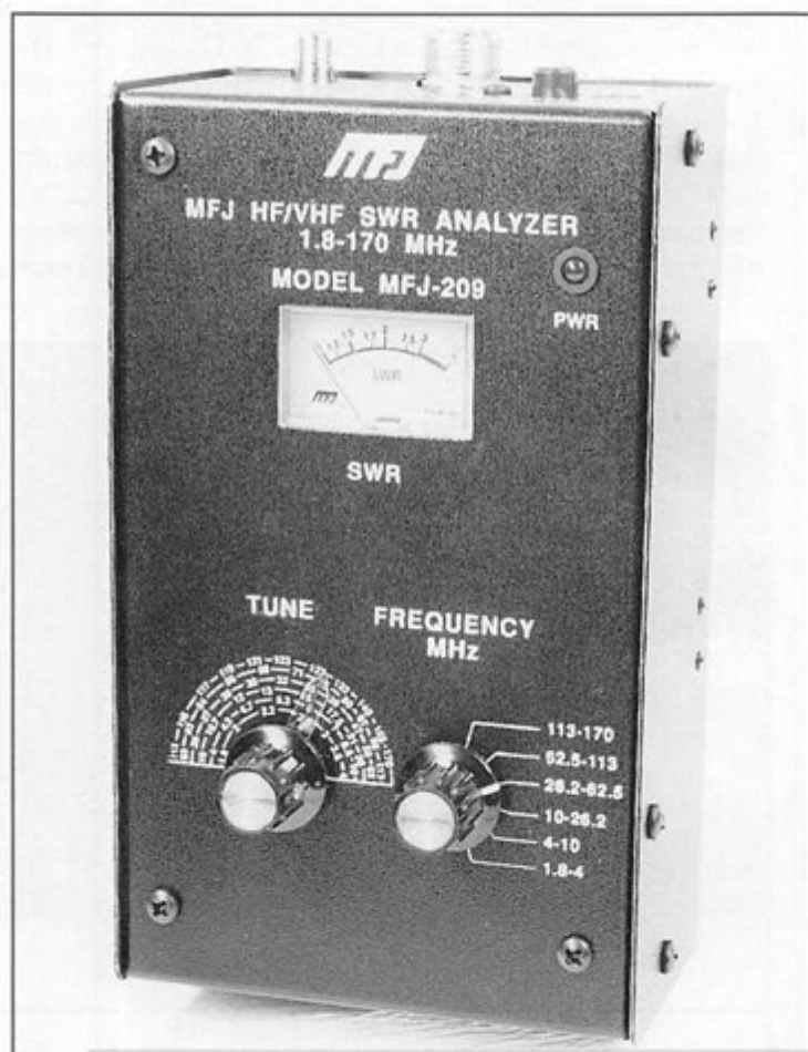
1. Le MFJ-209, un analyseur de ROS autonome.
