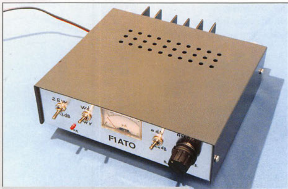
Photo 1. Le transverter prêt à fonctionner.
