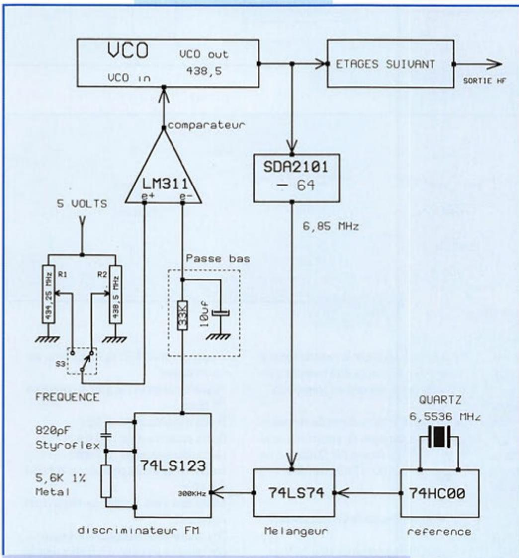
Figure 3. Principe de la stabilisation en fréquence.
