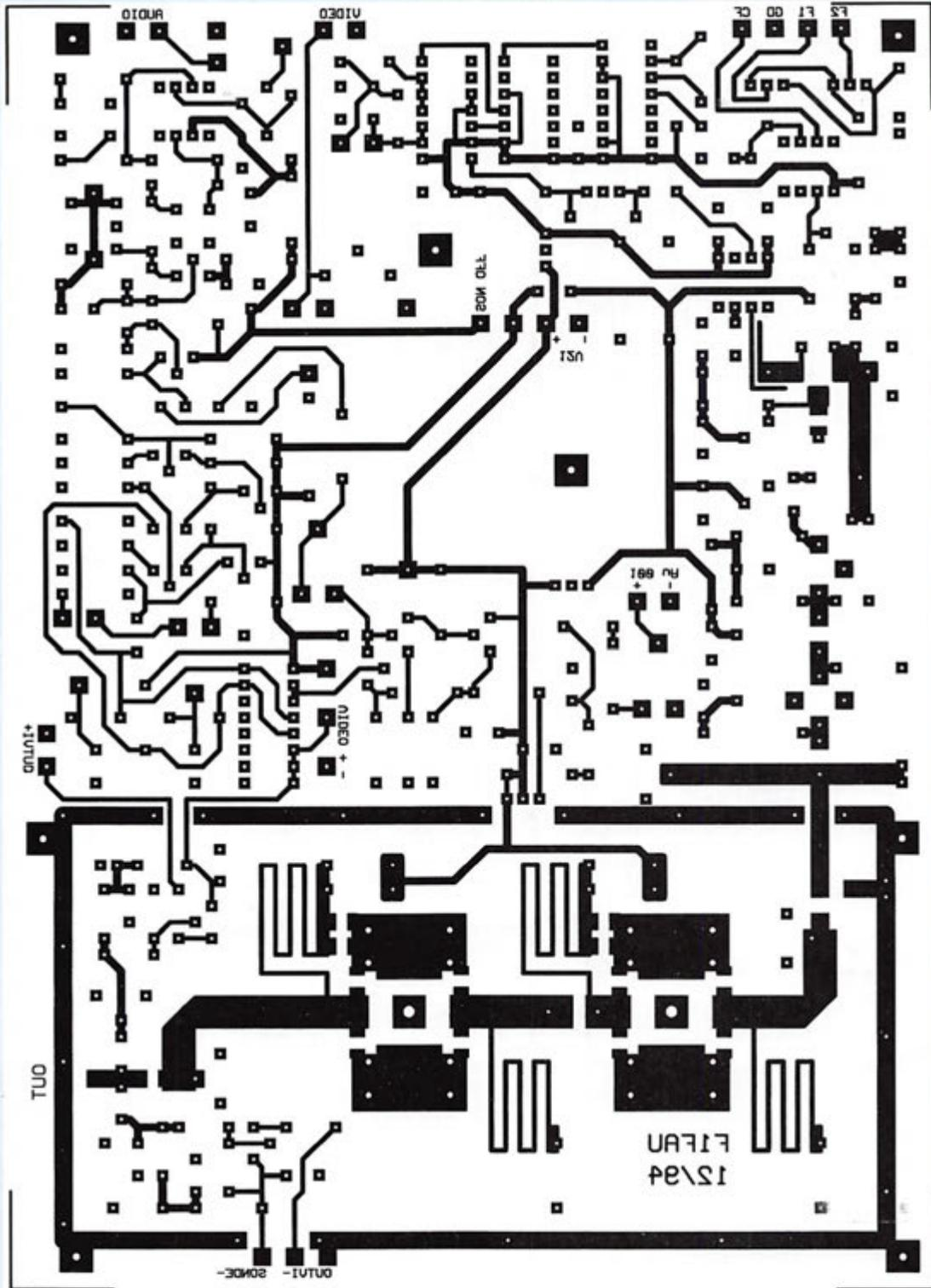
Figure 6. Circuit imprimé, pistes vues côté composants.
