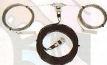
sentiraient incapables d'en construire une, MFJ propose sa solution, avec le modèle 1778. Le succès de ce type d'antenne provient du fait qu'elle couvre toutes les bandes amateurs, tout en restant plus courte qu'un dipôle 80 mètres. Elle peut être montée en ligne, en sloper ou en V inversé. Elle est livrée complète, avec ses isolateurs, sa descente en
