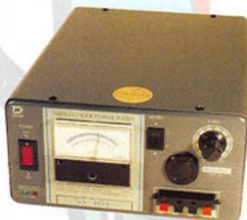
neau avant, on trouve un large galvanomètre qui mesure la tension et le courant, en fonction de la position du switch placé à sa droite. Les sorties se font sur un double bornier (pour courant faible, 6 A); pour la puissance, il faut utiliser les douilles en face arrière. Là encore, un réceptacle pour prise "allume-cigare" équipe la face avant. La ventilation mécanique se déclenche automatiquement (vu chez GES).
