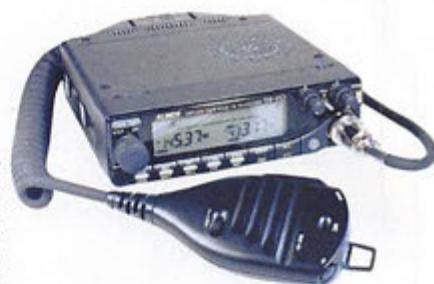
sée de l'appareil et placée à portée de main (prévoir le kit optionnel). Il couvre de 144 à 146 MHz et de 430 à 440 MHz. Les réglages de volume et de squelch sont séparés pour les deux bandes. La puissance de sortie, réglable en trois niveaux, atteint 50 W en 145 MHz et 35 W en 435 MHz. La sortie antenne est unique (duplexeur interne). Livré avec son micro, il n'attend plus qu'une alimentation capable de fournir 12 A pour fonctionner... (vu chez Euro Communication Equipements).
