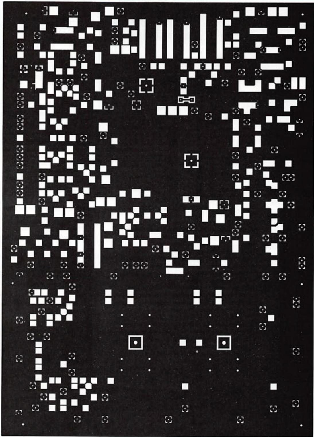
Figure 9. Circuit imprimé, plan de masse.
