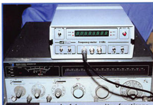
Le fréquencemètre fonctionne, on teste sa sensibilité.
