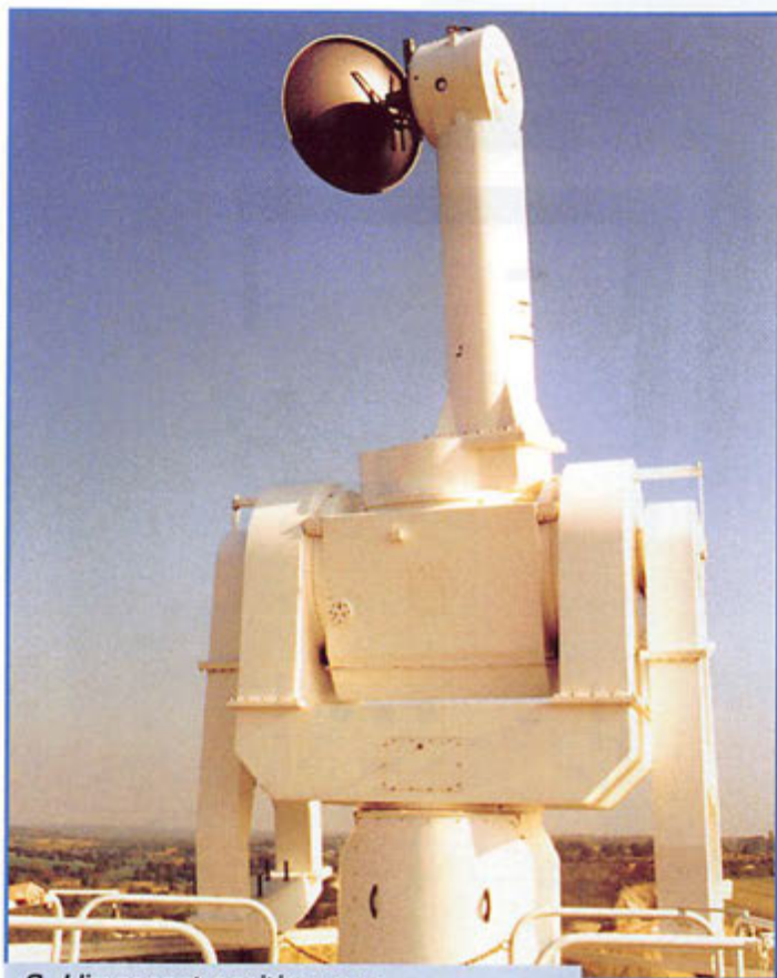
3. L'imposant positionneur pouvant accueillir des paraboles de 4 m de diamètre.
