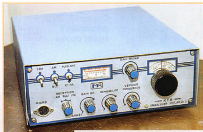
Le KT-8, un transceiver VHF AM et BLU.
