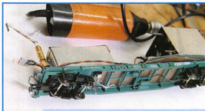
Position du micro, sans l'ensemble caméra + émetteur.
