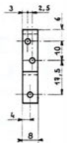
Désignation : support vis marteau Rep : ⑦ Nbre : 2 Matière : Cu Zn 15 Echelle : 1
