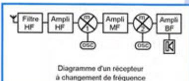
Diagramme d'un récepteur à changement de fréquence
