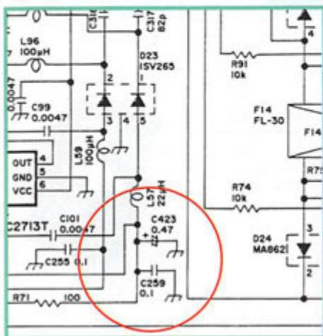
côté entrée du filtre (en émission). Il faut couper la trace entre le filtre FL30 référencé F14 sur le schéma et la résistance R78 (2,2 Kohms) et mettre la 100 ohms. L'ondulation se trouve ainsi limitée à moins de 2 dB. Nous n'en demanderons pas plus.
