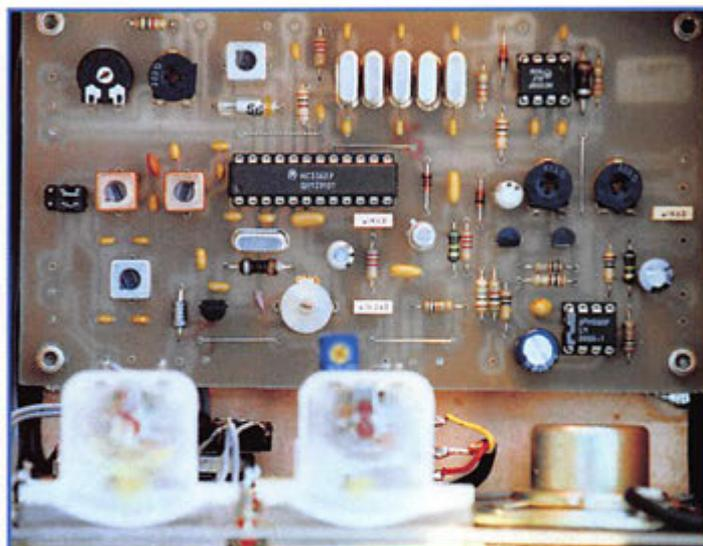
Régler P4 pour que l'aiguille du S-mètre soit sur zéro. P1 doit être réglé à fond dans le sens des aiguilles d'une montre. Pot2 doit être positionné à fond de façon à avoir le maximum de tension (aux alentours de 6 volts) sur la broche 23 du MC3362. Avec un générateur HF branché sur l'entrée antenne, injecter un signal d'au moins 50 microvolts réglé sur 7,000 MHz. Tourner le noyau de L4 jusqu'à entendre le signal dans le haut-parleur. Ne plus retoucher ce noyau.
