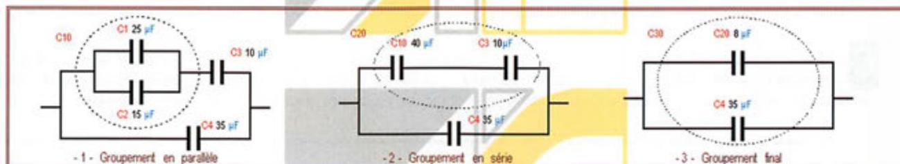
**Etape 1** Observons le schéma, le premier groupement simple de **condensateurs** que nous pouvons calculer est celui associant **C1** de 25  $\mu F$  & **C2** de 15  $\mu F$  qui sont en parallèle.
