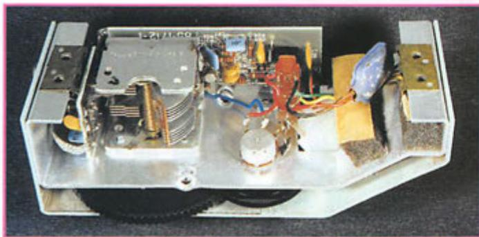
du "Dip", lorsqu'il se produit. Fournissons une précision utile: puisque le Grid-Dip est un oscillateur, le signal qu'il produit peut être reçu sur un récepteur ou un fréquencemètre sensible, ce qui permet alors d'augmenter la précision de la mesure de fréquence.
