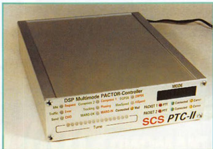
**Le PTC II est d'abord un contrôleur de communications en PACTOR. Mais il assure également le trafic en AMTOR, Baudot, CW... et en Packet (option). Le tout avec un brio dû au traitement des signaux par DSP. Accessoirement, ce DSP peut être utilisé à d'autres fins, mais c'est une autre histoire !**
