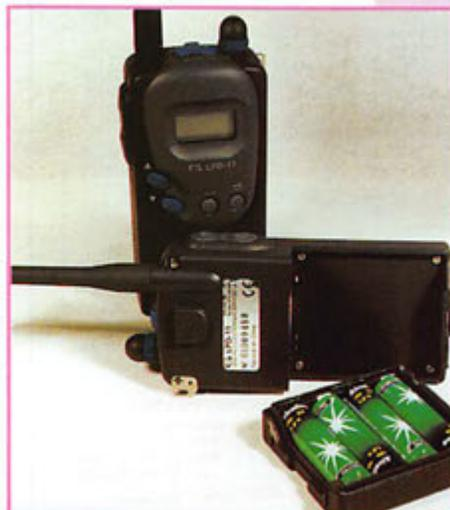
en balayage après 5 secondes. Définir une portée pour ce genre d'appareil est assez délicat. En zone pavillonnaire, nous avons, avec une paire de LPD-11 dotés de piles neuves, établi une communication jusqu'à 500 mètres. A vue directe, cette distance peut passer à 8 ou 900 mètres, peut-être plus... Dans tous les cas, les résultats sont suffisants pour des randonneurs, la surveillance de manifestations sportives, la com-
