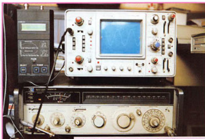
Le fréquencemètre mis à l'épreuve (ici, sur la BF du géné HF).
