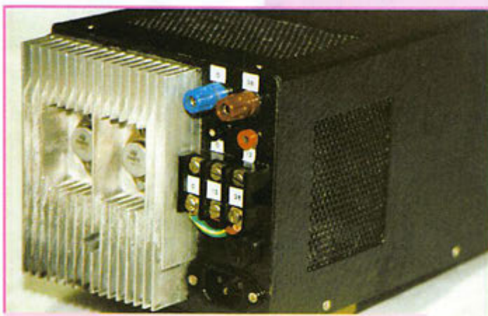
Face arrière de l'alimentation 24/28V. On distingue de haut en bas : les 2 douilles de sortie 28V 8A, les 2 douilles de sortie 12V 1A et le connecteur à vis pour le 28 et le 12V.
