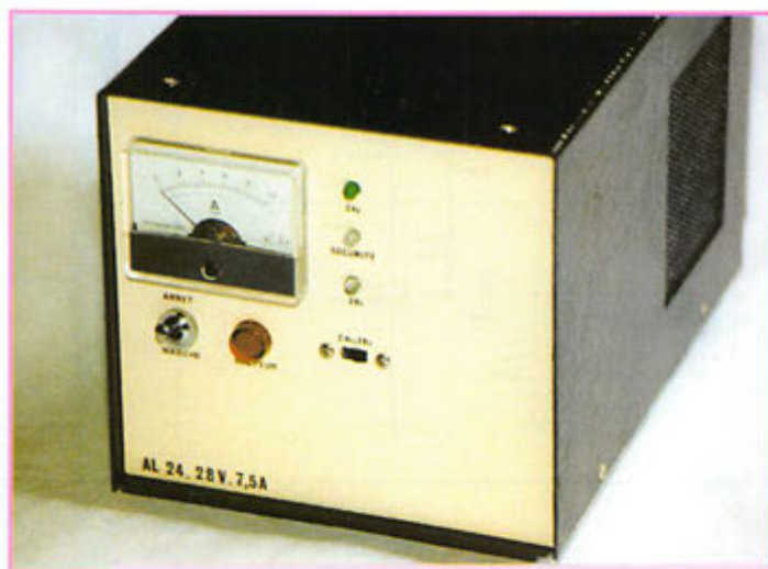
Face avant de l'alimentation 24/28V. On distingue les 3 leds dont le contrôle qui est bicolore. Le contacteur 24/28V.
