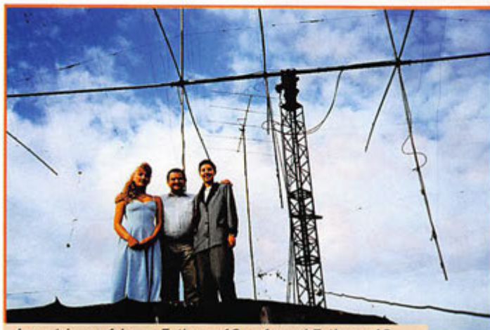
Les aériens : 1 beam 5 él. sur 10m, 1 quad 5 él. sur 10-15m & 4 él. sur 20m. Lika, F6GYM, Nika.
