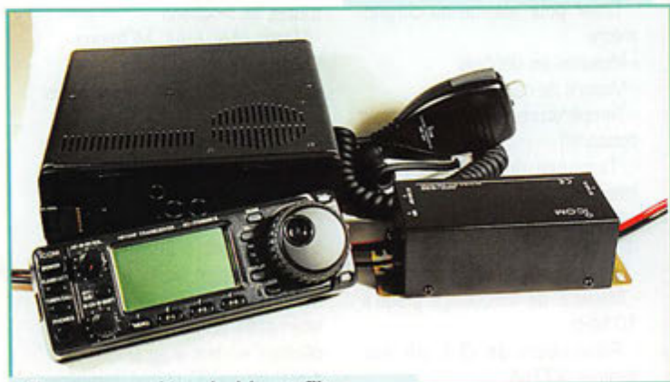
Face avant détachable et filtre d'alimentation.
