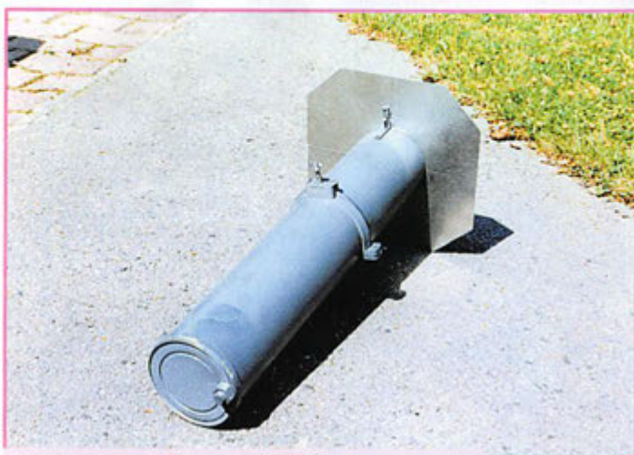
L'antenne munie de son capot plastique. Notez les équerres de consolidation au niveau du plan de masse ainsi que l'anneau permettant la fixation sur un mât.
