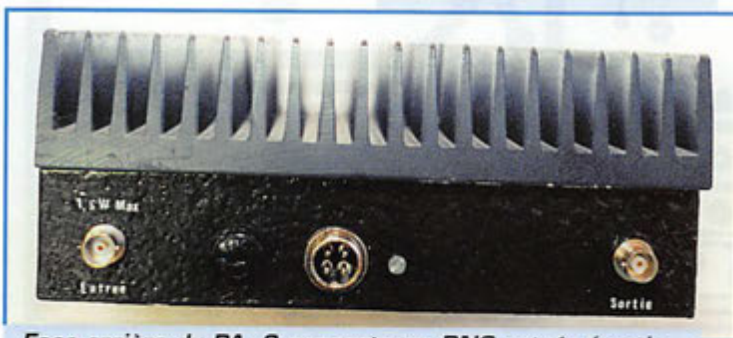
Face arrière du PA. 2 connecteurs BNC entrée/sortie HF, l'embase du connecteur 24 V et le porte-fusible.
