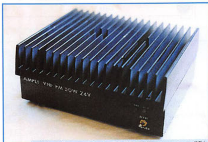
Vue d'ensemble du PA 50 W Thomson modifié pour application amateur 144-146 MHz
