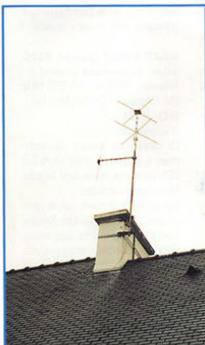
Antenne "Turnstile" pour les satellites défilants (137 MHz).
