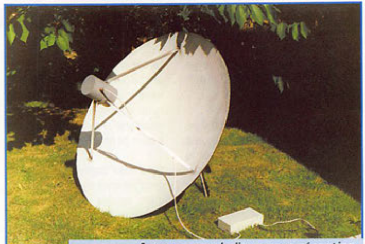
Antenne parabolique pour réception METEOSAT (1691 MHz).
