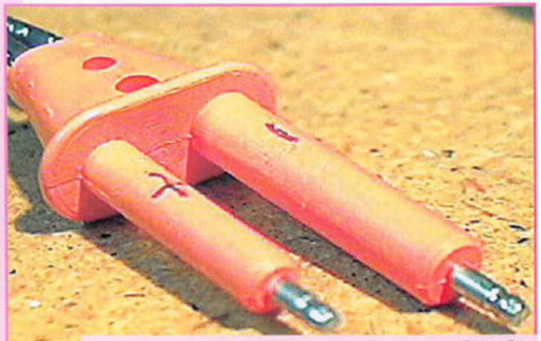
Photo 3 : La prise d'alimentation du laser, avec la polarité que j'ai ajoutée au crayon feutre pour éviter toute fausse manœuvre.
