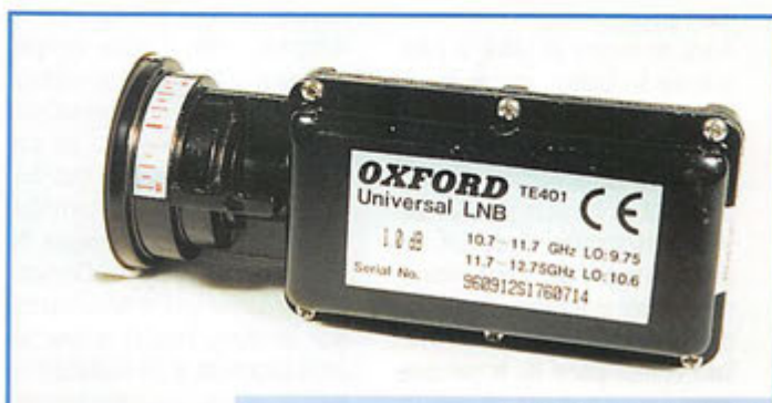
Une tête universelle avec commutation d'OL.
