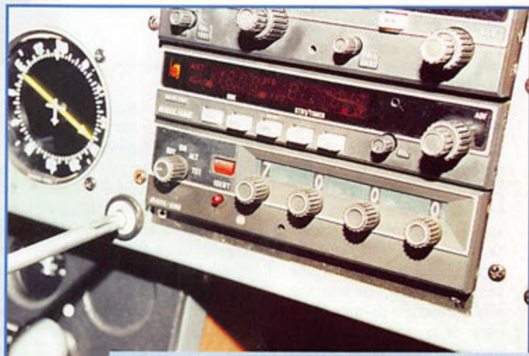
Le boîtier de commande du transpondeur sur un avion d'aéro-club. Ici, code 7000 affiché.
