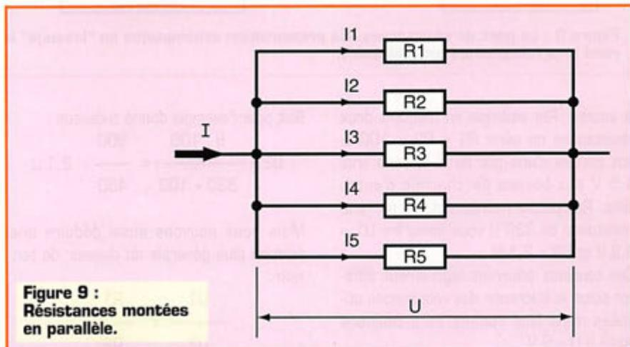
Figure 9 : Résistances montées en parallèle.
