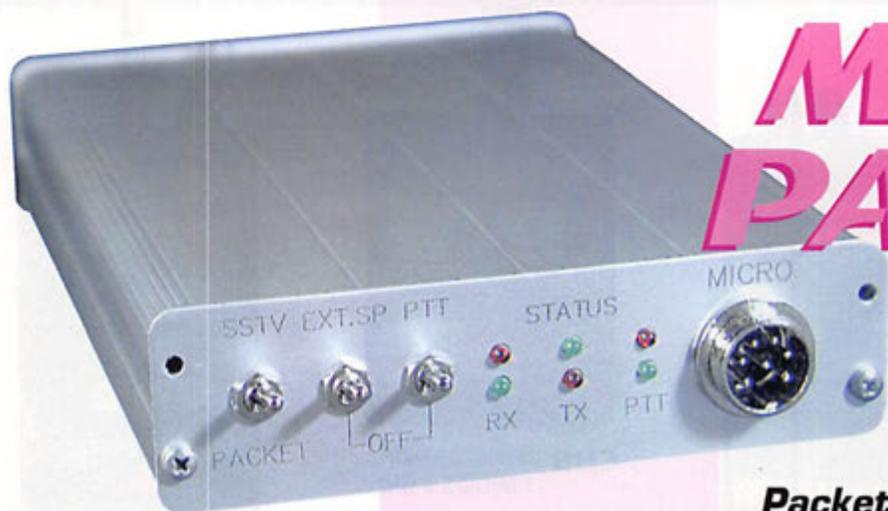
**Ce petit modem fonctionne dans les modes Packet, FAX, SSTV, RTTY, CW avec les logiciels connus, disponibles en libre-essai, tels que HamComm et JVFax.**
