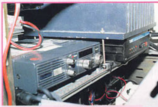
Rack émetteur UHF : émetteur Pro Elphora 433,025 MHz ; ampli UHF Tono.
