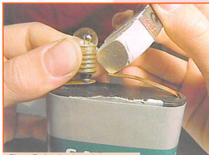
Photo 5 - Le plastique de la gomme est un isolant.
