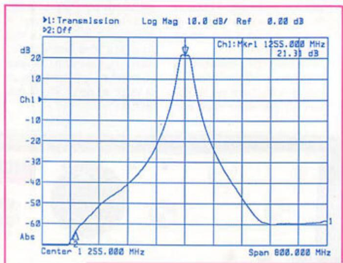
Réponse en fréquence hors bande du préamplificateur, le marqueur 2 est à 950 MHz.
