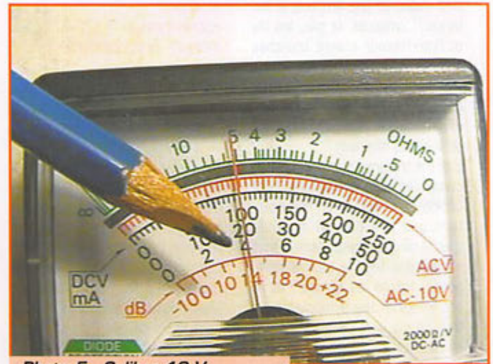
Photo 5 - Calibre 10 V on mesure 4 V.
