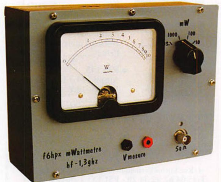
**L'appareil présenté permet les mesures de puissance, depuis 2 mW jusqu'à 1 watt, en trois gammes, 10, 100 et 1 000 mW. La mesure des puissances supérieures est naturellement possible avec l'utilisation d'atténuateurs extérieurs.**
