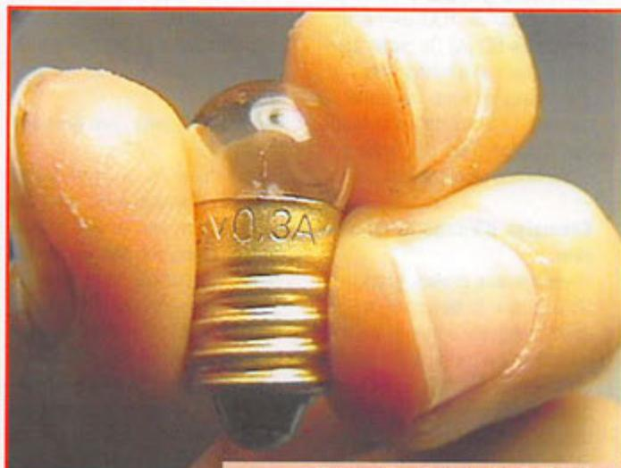
Photo 2 - Ampoule 3,5 volts 0,2 ampère.
