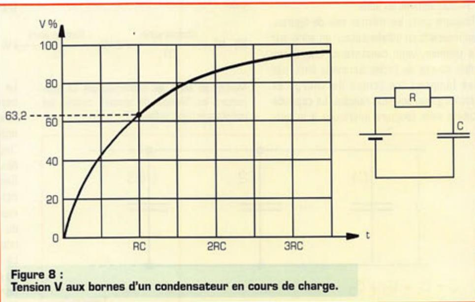
Figure 8 : Tension  $V$  aux bornes d'un condensateur en cours de charge.
