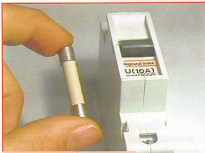
Photo 4 - Disjoncteur et fusible.
