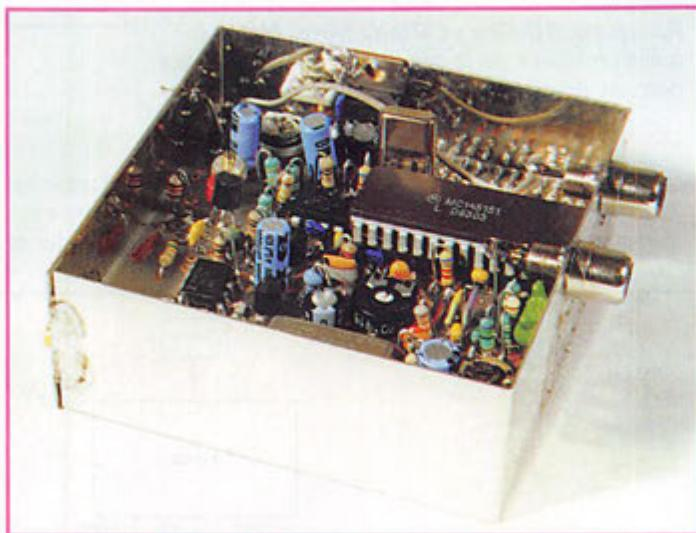
**Vous avez été nombreux à réaliser l'émetteur ATV 1,2 GHz. A la demande des lecteurs, je vous propose cet émetteur de télévision 2,3 GHz qui vous permettra de découvrir la transmission d'images dans une nouvelle bande. La puissance de sortie est de 30 mW.**
