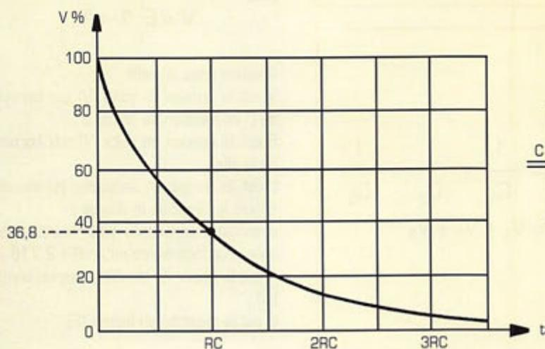
Figure 9 : Tension  $V$  aux bornes d'un condensateur en cours de décharge.
