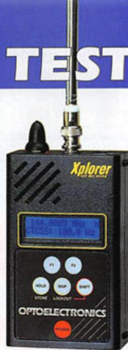
Capteur d'émissions FM proches. **XPLORER**
