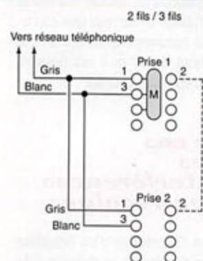
Dans le cas de terminaux récents (claviers à fréquences vocales) et sans sonnerie ancienne (électromécanique), deux fils suffisent.
