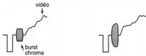
Figure 7 : A gauche, les bursts chroma d'une émission couleur. A droite ces mêmes bursts avec P1 à la masse et le CV réglé à l'accord sur 4,3 MHz.
