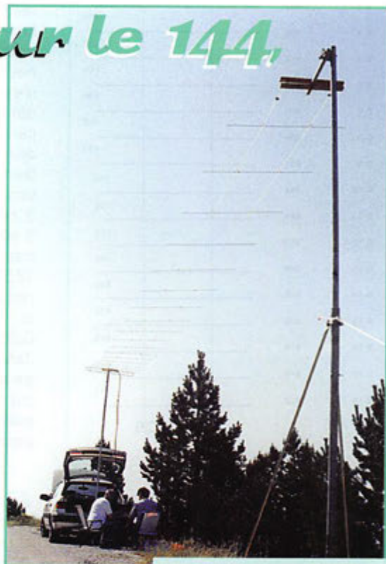
La "Yagi deux mètres déroulée" de F1DRN en ordre de marche. Le pointage se fait en déplaçant le côté opposé au trombone.
