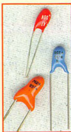
Figure 5 : Le condensateur au tantale à électrolyte solide (type « goutte »).
