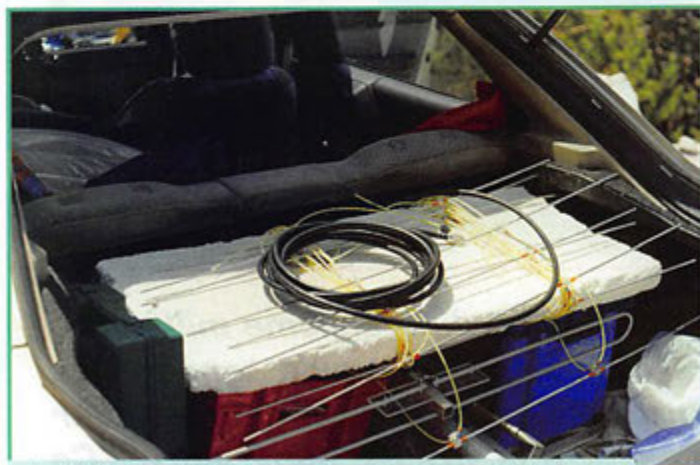
Une Yagi 144 MHz de 12,50 mètres dans un coffre de voiture... Le rangement des mâts-supports sera plus difficile à trouver !
