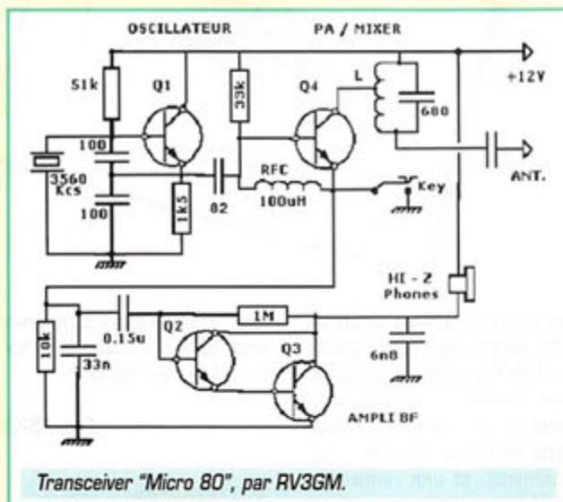
Le transceiver (si, si... j'ai bien dit le "transceiver") émet et reçoit sur la bande 80 mètres sur la fréquence du quartz (le très connu 3,5795 MHz à moins de 10 F étant aussi utilisé par les adeptes du GRP) et permet, luxe suprême, de faire du GSK.
