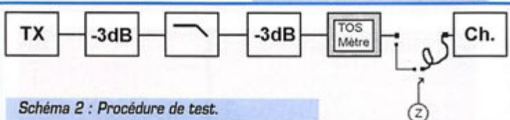
Schéma 2 : Procédure de test.
