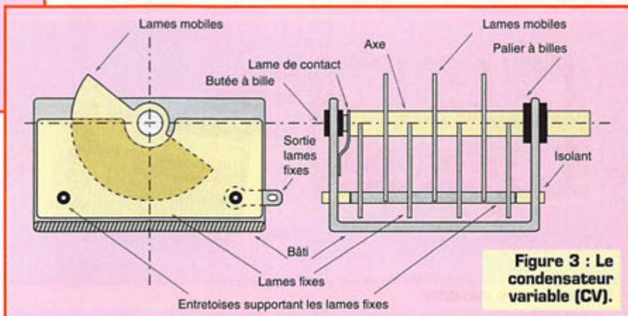
Figure 3 : Le condensateur variable (CV).
