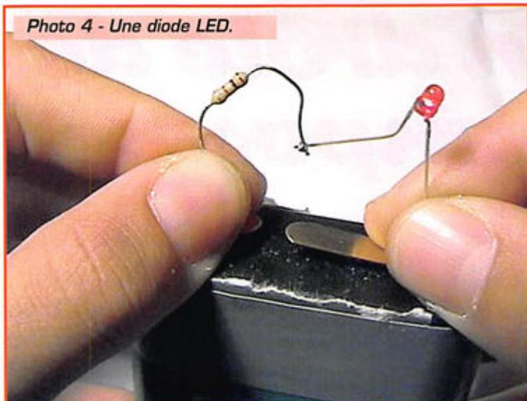
4,5 V. Tout se passe comme si la diode nous disait "OK, je laisse passer le courant dans le sens direct, mais je pique 0,6 volts au passage pour ma consommation personnelle, quelque soit le courant qui me traverse". Autre essai avec la diode au germanium, cette fois c'est 0,3 volts qui disparaissent. On n'y peut rien, il faut faire avec.
