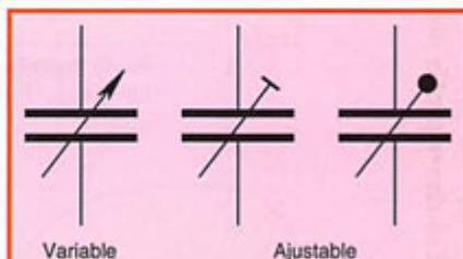
Figure 2 : Symboles des condensateurs variables et ajustables.
