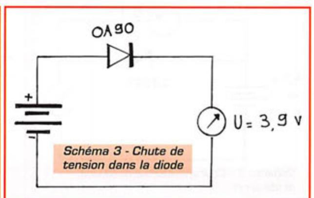
Schéma 3 - Chute de tension dans la diode
