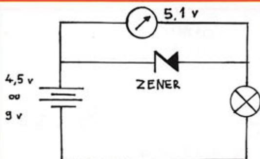
Schéma 5 - Courant inverse dans une diode zener.
