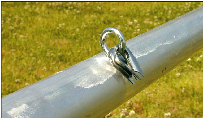
▲ La plaque de fixation au mât.
