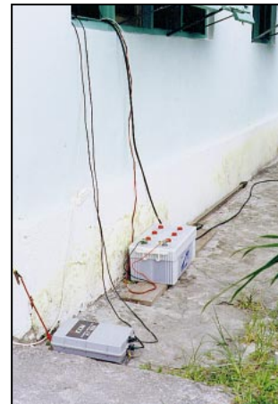
L'alimentation et la boîte d'accord.
