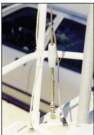
L'isolateur de la long fil et le balcon arrière. A droite, le mât de l'éolienne.
