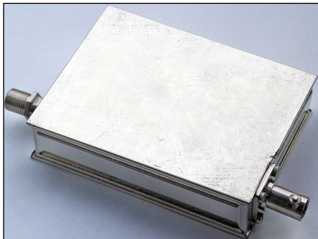
Figure 15 - Convertisseur abaisseur pour la bande 1,9 GHz.
