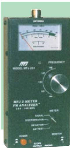
**MFJ-224** Analyseur de signal HF bande VHF. Mesure la force du signal, l'excursion FM, les antennes (gain, largeur du lobe, rapport Av/Ar, suppression lobes latéraux), la perte dans les lignes. Sorties pour oscilloscope et casque. Alimentation par pile 9 V avec témoin de décharge.
