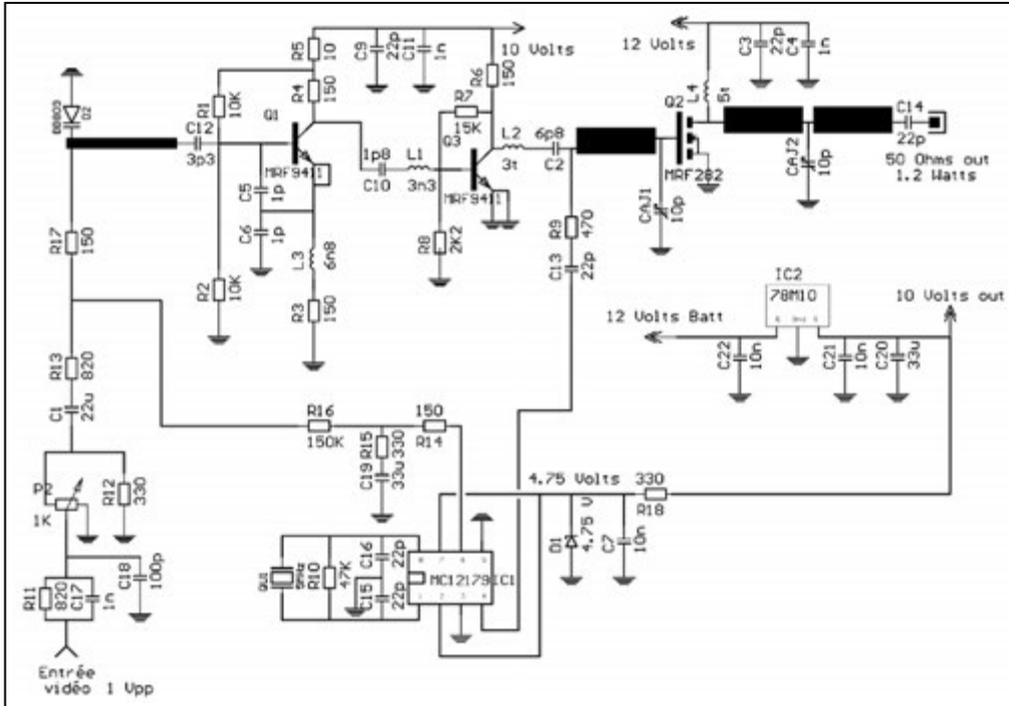
Schéma de l'émetteur vidéo FM sur 1280 MHz.
