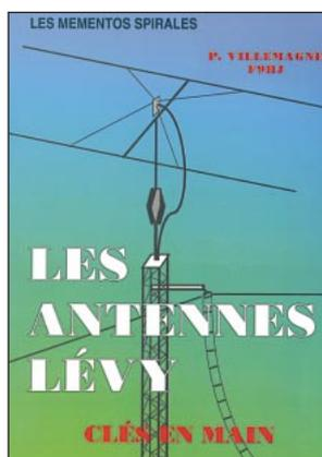
L'antenne Lévy est, avec le long fil, le seul dipôle à pouvoir couvrir toute l'étendue des ondes décimétriques, à condition que sa ligne soit un twin-lead étroit. Comme elle fonctionne en vibration forcée, elle est accordable sur n'importe quelle fréquence. Par sa totale symétrie par rapport à la terre, et ce, sur chaque bande, elle évite les incompatibilités électromagnétiques ce qui sera fort apprécié du voisinage !
