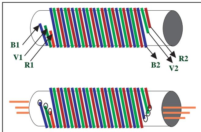
Figure 2 - Bobinage à 3 fils d'un balun.
