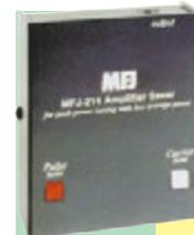
**MFJ-214** Boîtier de réglage pour amplificateur HF. Génère un signal impulsionnel de faible puissance moyenne permettant d'accorder l'amplificateur pour sa puissance maximale tout en protégeant l'étage de sortie. Réglages internes indépendants de la vitesse et du rapport des impulsions. A brancher dans la prise CW de l'émetteur. Alimentation par pile 9 V.
