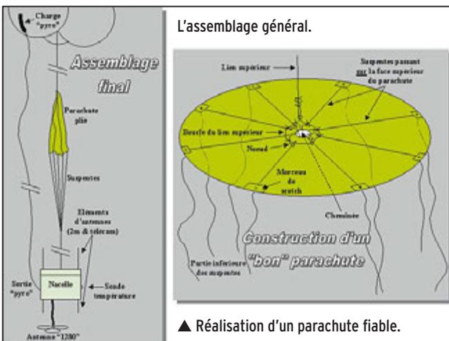
▲ Réalisation d'un parachute fiable.
