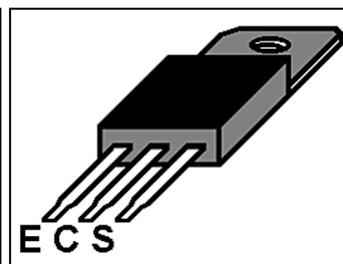
Schéma 4 - Circuit intégré régulateur de tension.
