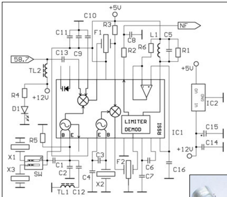
Figure 17 - Schéma du récepteur.
