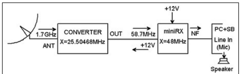
Figure 16 - La solution la plus simple pour recevoir Météosat.
