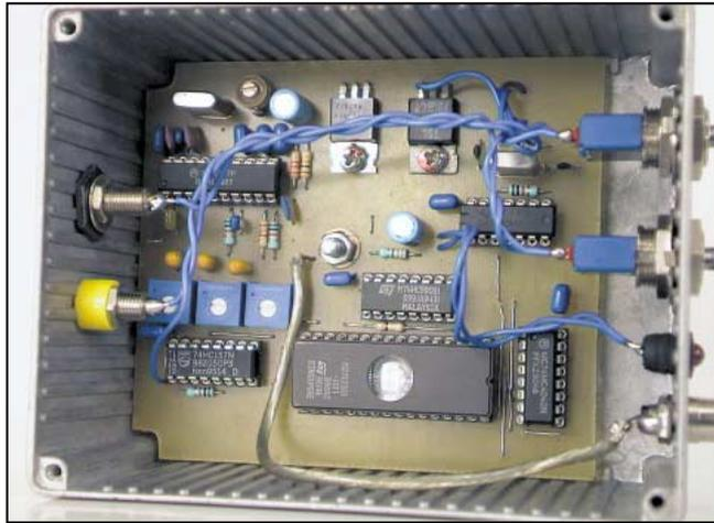
Un signal de remise à zéro (reset) des compteurs est généré par l'EPROM au bout de 160 000 adresses :  $160\,000 \times 250\text{ns} = 40\text{ms} = 2$  trames = 1 image. Il est à noter que cette mire a une vraie synchro (égalisation avant-arrière et suppression trame). Certains vous diront que l'on pourrait « reseter » les compteurs au bout d'une trame, sachant que les 2 trames sont identiques, sauf au niveau de
