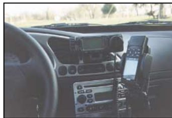
Photo 1.2 : Montre l'installation des supports sans perçage. Ici, utilisation du support universel pour le GPS12. Le support est fixé par 2 tiges enfilées dans les 2 trous de verrouillage auto-radio.
