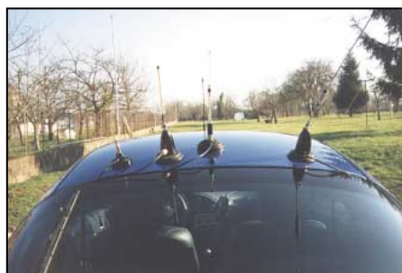
Photo 3 : Vue sur les antennes magnétiques VHF, UHF, SHF. A remarquer, les câbles qui passent sous les joints de coffre.
