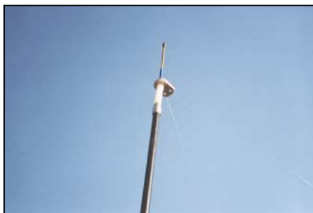
Photo 7 : Le haut du fouet 40 m tenu par des fils de nylon.
