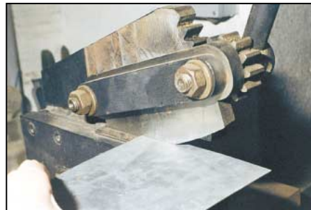
Photo 5 - Découpage de la tôle.
