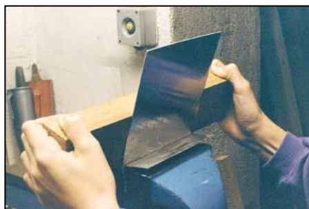
Photo 8 - Pliage d'une tôle mince.
