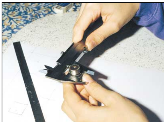
Photo 2 - Déterminer le diamètre des trous à percer.
