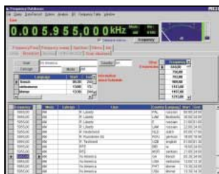
FREQUENCY MANAGER : Choix d'une station broadcast et envoi de la fréquence au récepteur.
