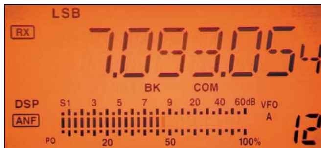
Affichage LCD (ici noter la présence du DSP et le pas de 1 Hz).
