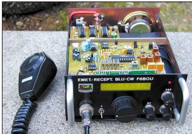
câble blindé, l'entrée du fréquencemètre à la broche 7 du NE612 (au travers d'un petit condensateur de 3,3 à 47 pF au plus près de la broche). Reprendre éventuellement les réglages de l'oscillateur local du récepteur pour corriger l'étalement de la bande. Si le strap est enlevé, toutes les entrées-sorties redeviennent actives. C'est le cas qui nous intéresse dans la réalisation de cet émetteur-récepteur, ainsi que dans tous les autres montages superhétérodynes (à changement de fréquence).
