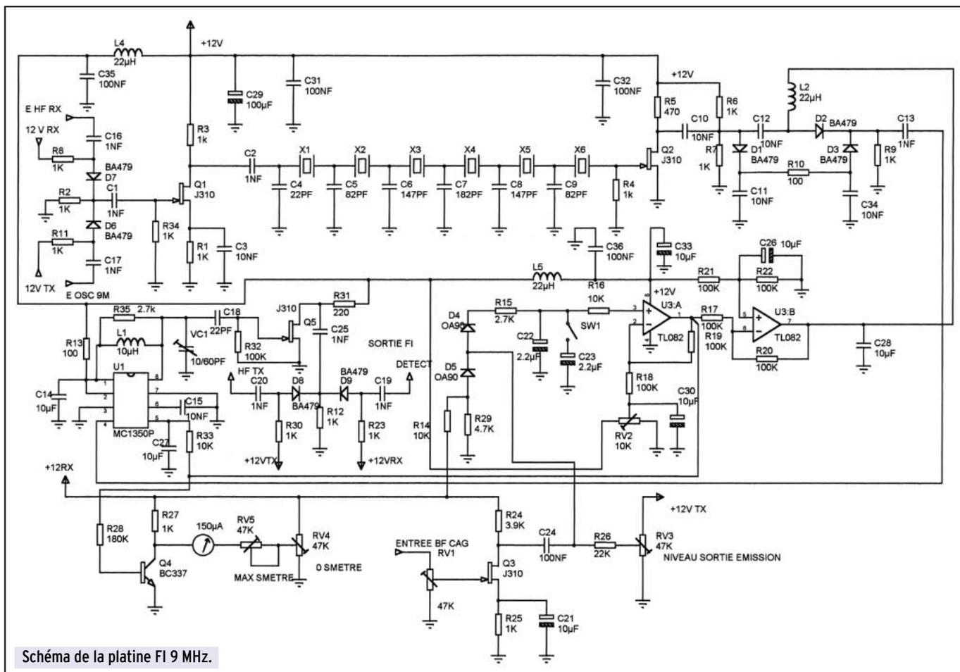
Schéma de la platine FI 9 MHz.
