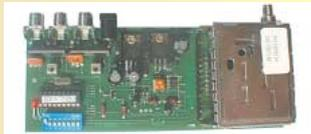
Caractéristiques communes : platines montées et testées, alimentation 13,8V, sorties audio (6,0 et 6,5 MHz modifiables en 5,0 ou 5,5 MHz) et vidéo sur RCA, sortie HF sur SMA femelle, fréquences fixes (1255, 1250, 1285, 1286,5, 1247, 1282,5, 1279,5 MHz).
