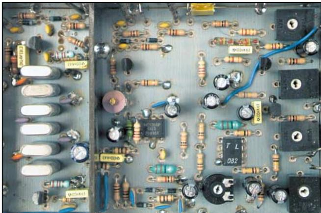
Un blindage sera interposé à l'emplacement matérialisé par un trait sur le schéma d'implantation, pour bien séparer le filtre à quartz du reste du montage. Un trou sera pratiqué dans le bas, pour le passage de L4.
