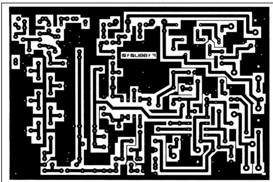
Circuit imprimé de la platine FI 9 MHz.
