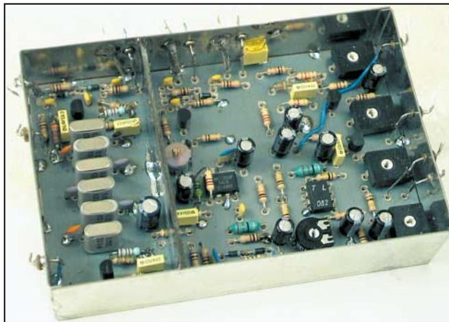
Le filtre en échelle à six pôles est réalisé à partir de quartz identiques, même fréquence et même fabricant.
