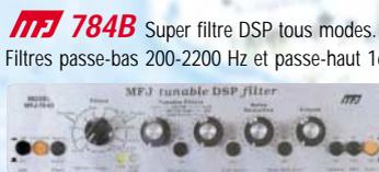
**MFJ 784B** Super filtre DSP tous modes. Filtre notch automatique 50 dB. Réducteur de bruit 20 dB. Filtres passe-bas 200-2200 Hz et passe-haut 1600-3400 Hz réglables. Filtre passe-bande 50-680 Hz avec fréquence centrale 300-3400 Hz. 16 filtres pré-réglés reprogrammables par l'utilisateur. Fonction by-pass. Amplificateur BF de contrôle avec sortie haut-parleur externe ou casque. Alimentation 12 Vdc.
