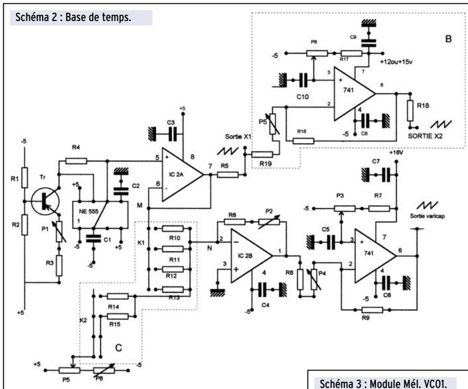
Elle produit, d'autre part, la dent de scie 0 à 15 V qui alimentera VCO1. Avec 15 V, l'oscillateur couvre de 280 à 480 MHz.
