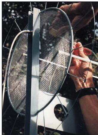
Montage de l'adaptateur d'impédance sur la 430 MHz.
