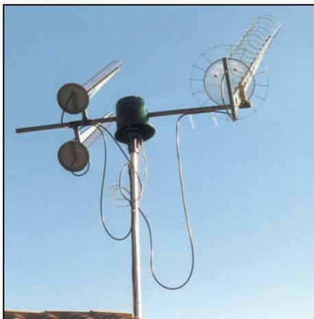
Une 430 MHz en test, faite dans le même esprit que les deux 1,2 GHz.
