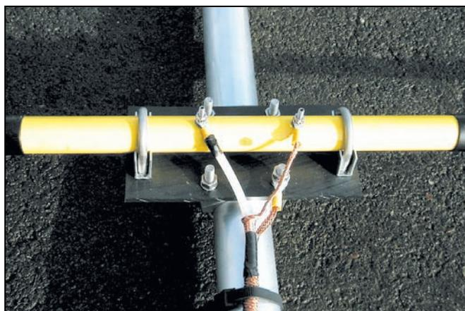
La fixation du câble coaxial et la mise à la masse.
