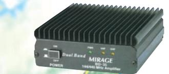
**BD-35 Mirage** Amplificateur linéaire VHF/UHF. Sortie 30 à 45 W (VHF) et 16 à 35 W (UHF) pour 1 à 7 W d'excitation (conçu pour utilisation avec TX portatifs). Sélection automatique de bande. Commutation automatique émission/réception. Fonction full-duplex. Connecteurs uniques en entrée et en sortie pour raccordement d'émetteurs et d'antennes bi-bandes. Protection contre les inversions de polarité.
