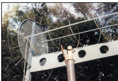
Adaptateur d'impédance non monté sur cette photo. Il était constitué d'une petite plaquette de cliquant de cuivre, fixée suivant le même principe que pour l'antenne 1,2 GHz.
