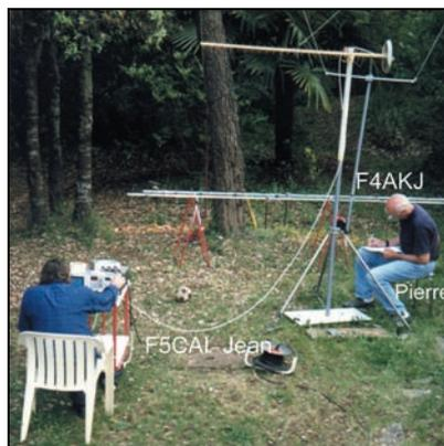
Opération de relevé du diagramme de rayonnement élémentaire d'une 1,2 GHz « moule à tarte ». Je n'ai plus les documents des mesures concernant ces antennes 1,2GHz.
