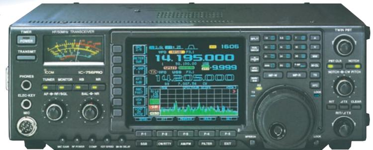
**IC-756 pro** Emetteur/récepteur HF + 50 MHz avec un afficheur TFT couleur de 14,5 cm multifonctions avec choix de couleurs et de caractères. Modes AM/FM/CW/USB/LSB/RTTY. Sortie 100 W (40 W en AM). DSP 32 bits : 51 filtres bande passante, réducteur de bruit, notch automatique et manuel, AGC, compresseur de modulation. Double veille. Décodeur RTTY. Analyseur de spectre. Twin PBT. Affichage analogique et digital des niveaux. 101 mémoires dont 2 mémoires de limite de bande. Coupleur
