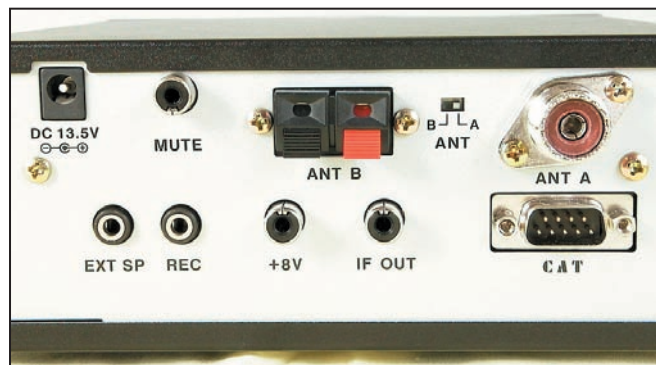
Notez la commutation des deux entrées antenne.
