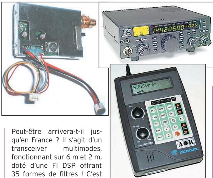
Peut-être arrivera-t-il jusqu'en France ? Il s'agit d'un transceiver multimodes, fonctionnant sur 6 m et 2 m, doté d'une FI DSP offrant 35 formes de filtres ! C'est une première dans le genre, en terme d'appareils destinés aux VHF... Grâce à ses deux connecteurs antennes et à ses circuits de commutation pour amplis linéaires séparés, il permet de tra-
