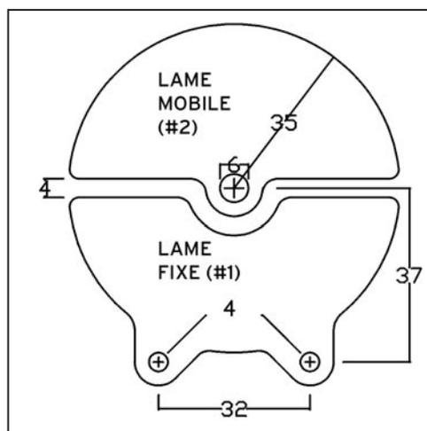
Figure 1 : Les lames fixes et mobiles.
