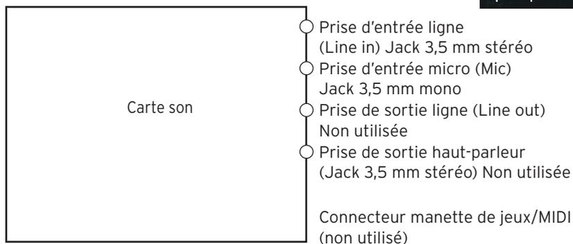
Soit la prise d'entrée ligne soit la prise d'entrée micro est utilisée ainsi que la sortie H.P (qui doit être reliée à l'entrée RTTY (AFSK IN)).
