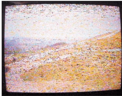
Photo 17-2 : + 6 dB après. Réception avec démodulateur satellite.
