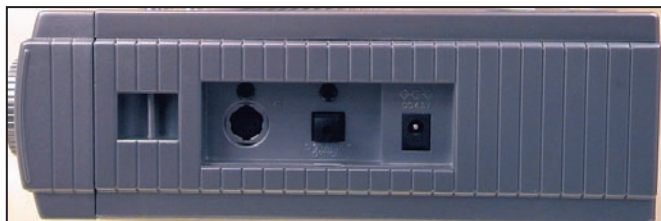
Mini DIN, sortie optique et alimentation sur le flanc droit.
