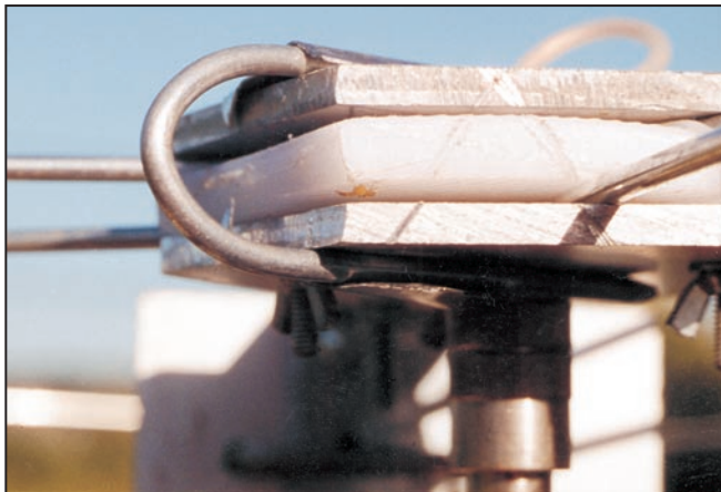
Le trombone d'accord, ou "stub" établit un contact électrique entre la masse et la partie supérieure, son déplacement permettra l'accord précis de l'antenne.
