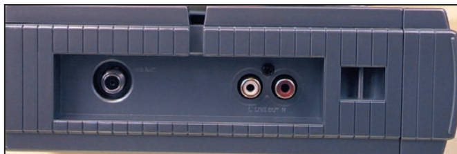
Prise antenne et sorties RCA sur le flanc gauche.
