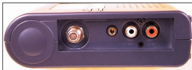
Une vue des prises côté antenne et audio.
