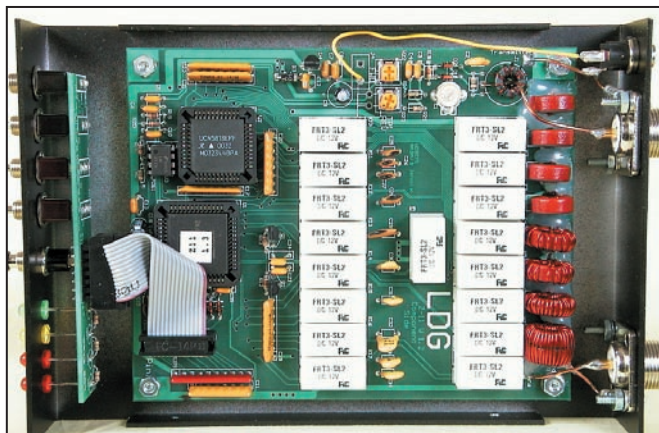
A l'intérieur, les relais qui commutent selfs et capas.
