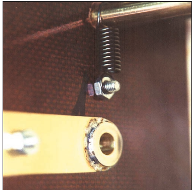
▲ Fig. n° 12 : Détail coussinet ressort vis. ▼ Fig. n° 13 : Bobine terminée.
