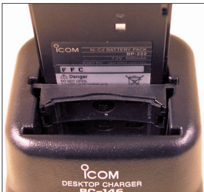
Grâce à une "cale" la batterie peut être chargée seule.
