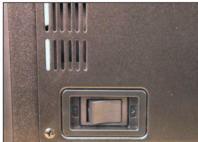
Le gros switch de commutation des batteries.
