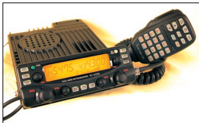
Photo 1 : On notera la possibilité d'incliner le panneau avant mais également la taille respectable du haut-parleur.
