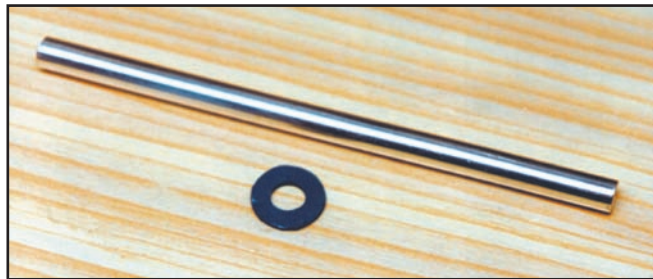
3 - Tige centrale et rondelle de plastique du centre.
