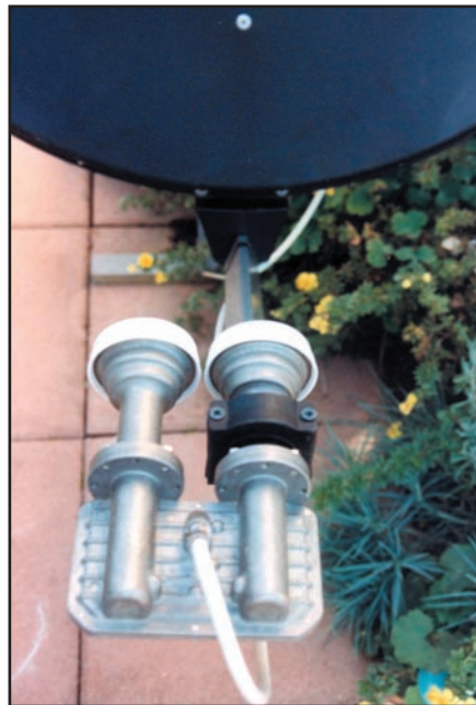
Figure 10: Tête monobloc, Astra en latéral avec DiSEqC.
