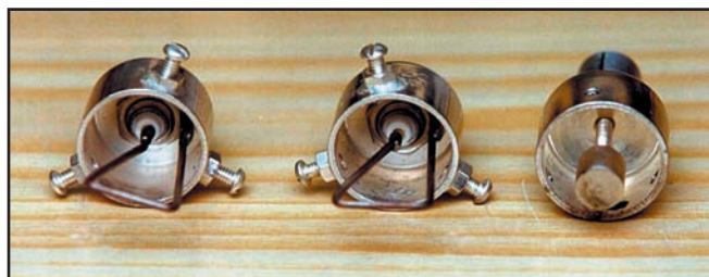
7 - Boutons de couplage et de réglage.
