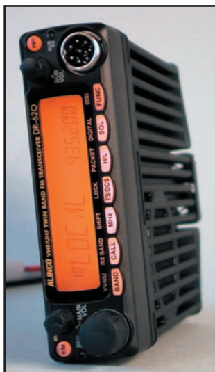
2 - Le panneau avant peut-être retourné de 180 degrés.
