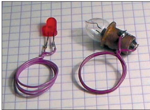
figure 1: Deux "boucles de Hertz".
