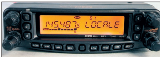
3 - Ici, la fréquence UHF a été nommée "Locale". Notez la symétrie du panneau avant.
