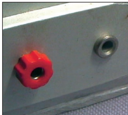
2 - Une douille banane pour l'antenne, une douille banane pour la terre.
