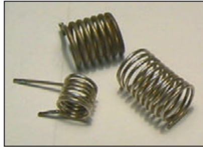
Figure 5 : Bobines en fil de cuivre argenté.
