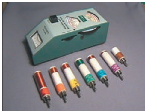
Figure 2: Un grip-dip ou dip-mètre et ses bobines
